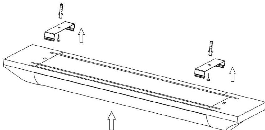
Рисунок 1. Монтаж светильника на рабочую поверхность
