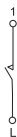
k) выключатель с самовозвратом / biased switch / өзі қайтатын бір пернелі ажыратқыш / intrerupator singură automat cu resetare
