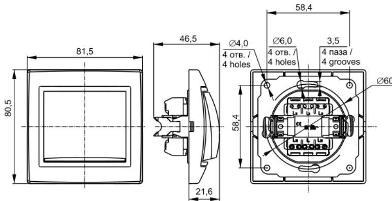
**Примечание** – Предельное отклонение габаритных размеров  $\pm 0,5$  мм. /
