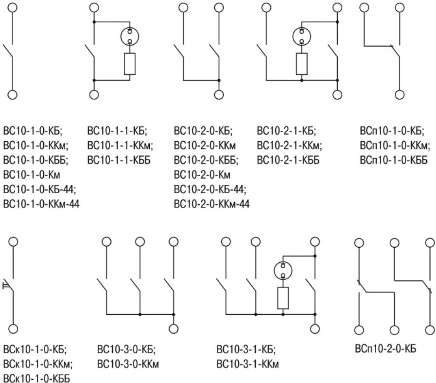
Рисунок 1 – Электрическая схема выключателя серии KVARTA /
